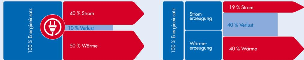
**Das Blockheizkraftwerk:** hohe Effizienz mit wenig Verlust durch dezentrale, gekoppelte Energieerzeugung
